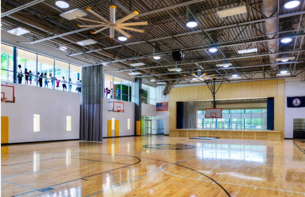
Bu fotoğrafta suni aydınlatma yok. Okulun jimnastik salonunu güneş tüpleri ile aydınlatılıyor. Fanlar ısıtma ve soğutma yüklerini azaltıyor. Bu salon kentlilere de açık. Foto © Prakash Patel
